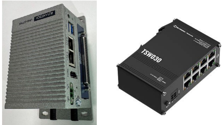
☒ Industriecomputer (links); Switch (rechts)
